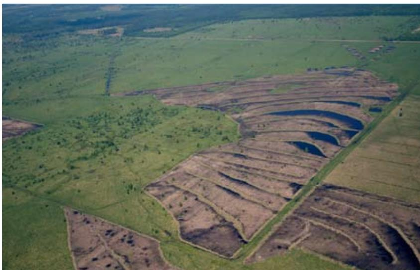
Fagne des 2-séries. Fraisage et mise en endains des résidus broyés sur 70 ha de tourbière dégradée par la molinie
